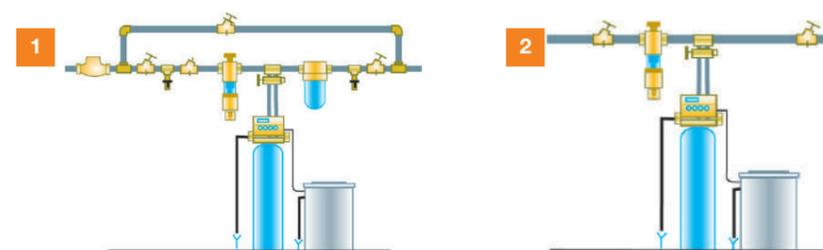
1 - Esquema de instalación descalcificador para agua potable con filtro y dosificador.
