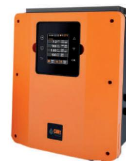
El sistema **CILLIT Smart JOLLY BLEEDOFF** permite controlar la máxima concentración salina en el circuito para evitar, conjuntamente con la utilización de los productos adecuados y los equipos CILIT, deposiciones, incrustación y corrosión en todos los puntos del circuito, como por ejemplo en la torre de refrigeración, en las tuberías y en los intercambiadores.
