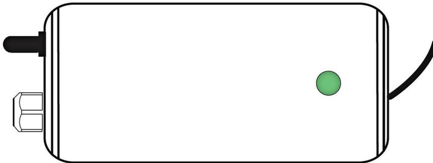
En este equipo el sistema de control incorpora un LED verde que indica que la lámpara UV está “Encendida”.
