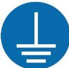
Este símbolo indica que el sistema se debe conectar únicamente a un enchufe adecuadamente conectado a tierra y protegido con un interruptor de circuito de fallos de conexión a tierra (GFCI) a través de un magnetotérmico y un diferencial.
